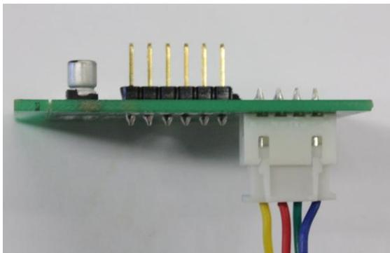
Kabel in RS-232-Platine einstecken
