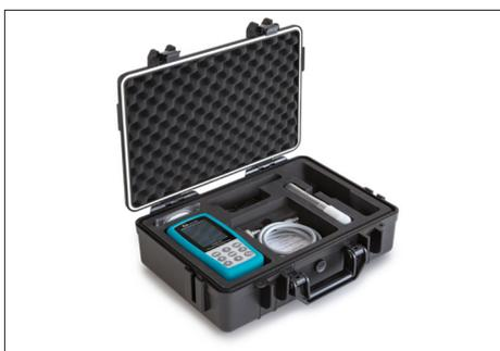
Materiale in dotazione: Blocco di durezza standard (ca. 61 HRC), cavo USB, unità display, unità sensore UCI, valigetta per il trasporto, software per il trasferimento dei dati salvati al PC, involucro protettivo (turchese), altri accessori
