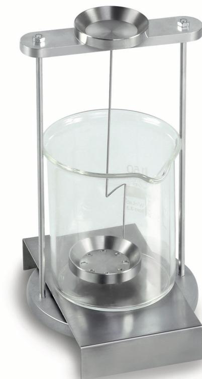
Jeu de détermination de la densité des matières liquides et solides avec une densité  $\rho = 1$
