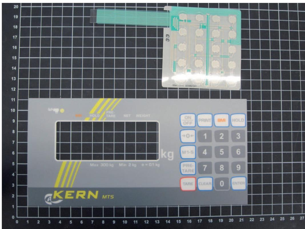
Lamina della tastiera, Adatto a modello KERN MTS 300K100M
