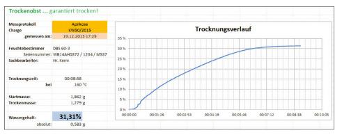
Messprotokoll mit Verlaufsdiagramm einer Feuchtebestimmung
