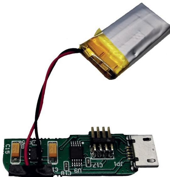
Placa de circuito, circuito de carga de la batería + batería
