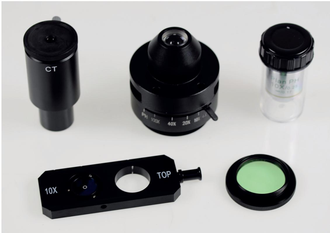
Phasenkontrasteinheit Einzeleinschub mit 8 PH-Plan-Objektiv 10×, für OBN-1
