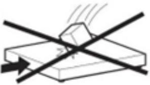
Evitar la caída de objetos sobre el puente, cargas repentinas (percusiones) y golpes laterales.
