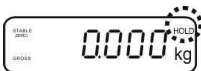
⇒ Colocar o material pesado no sistema de pesagem e esperar até que se acalme um pouco.
