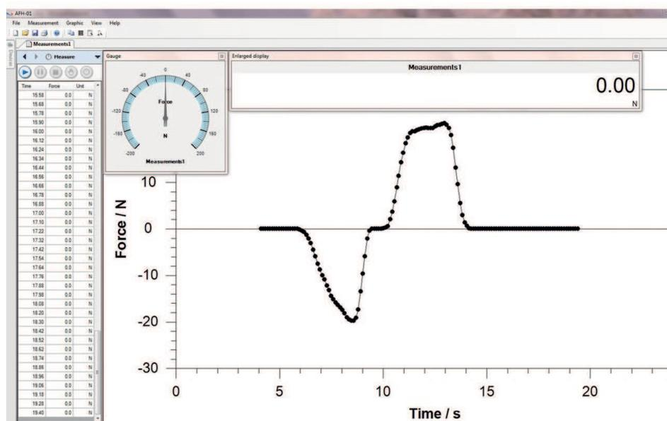
Logiciel de transmission des données pour les mesures de force-temps
