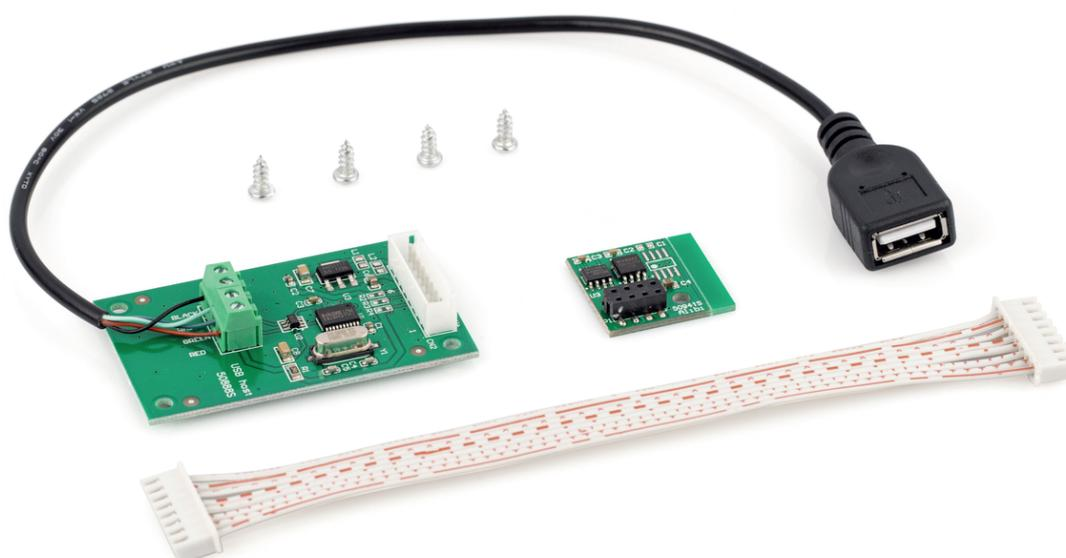
Mémoire alibi, avec interface USB pour l'exportation des résultats de pesée vers des supports de données externes, tels que les clés USB, les disques durs, etc.
