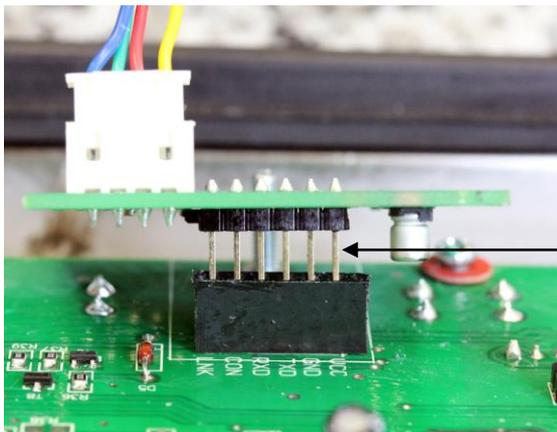
Enchufar la placa de circuitos impresos RS-232 en la placa principal de circuitos impresos
