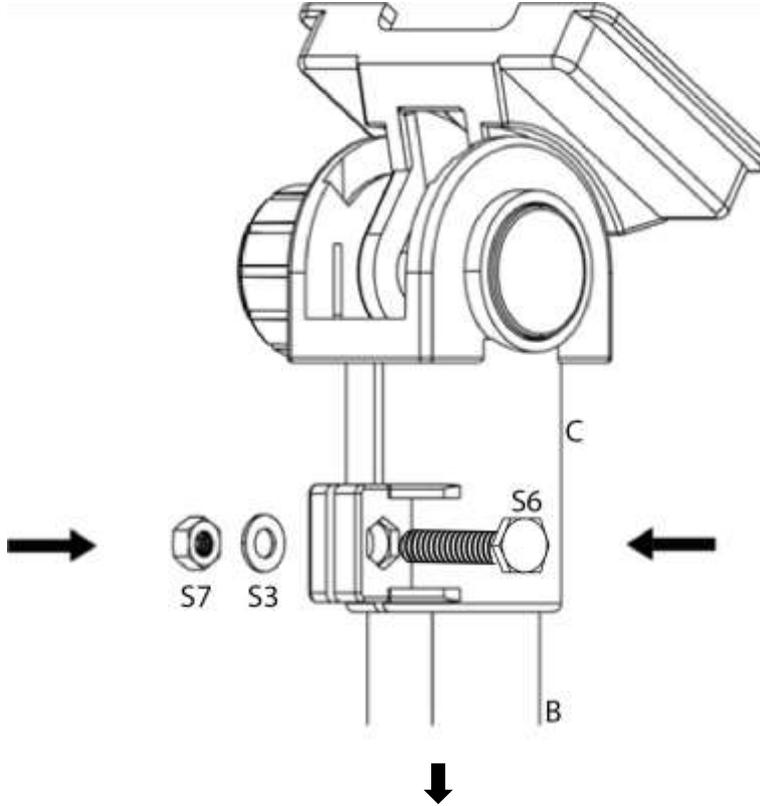
⇒ Insérer le support (**C**) pour l'appareil d'affichage dans l'extrémité supérieure du tube du trépied (**B**) et le fixer avec la vis (**S6**).
