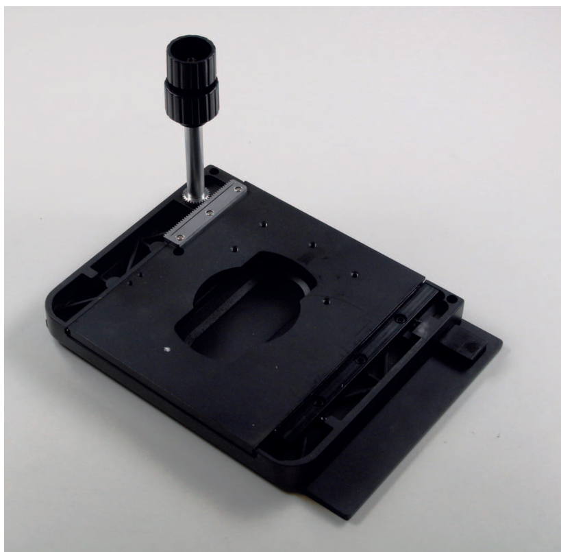
Tavolino meccanico a croce per microscopi metallografici
