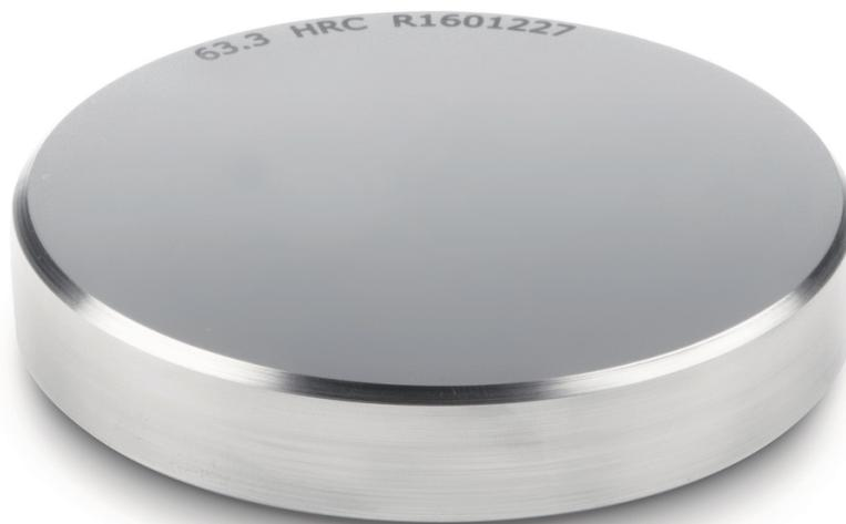
Kalibrier- und Justierplatte (Härtevergleichsplatte) mit definierten und geprüften Stahlhärten zur regelmäßigen Prüfung und Einstellung von Härteprüfgeräten
