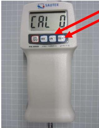
3. Après quelques secondes, le **poids d'ajustage** nécessaire apparaît sur l'écran, par exemple 5,00kg pour le FK 50 ou 10,00kg pour le FK 100.
