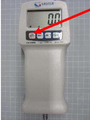
2. Dès que l'écran affiche "0", appuyer simultanément sur le bouton **"UNIT"** et sur le bouton **"ZERO"** jusqu'à ce que **"CAL"** apparaisse sur l'écran.
