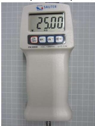
4. Le poids correspondant est alors accroché au crochet. L'appareil **doit être maintenu immobile pendant que le poids est accroché** ; il faut éviter de trembler. Conseil : l'appareil doit être tenu à deux mains, les deux coudes étant appuyés sur une table, ou être fixé à un objet fixe (banc d'essai).
