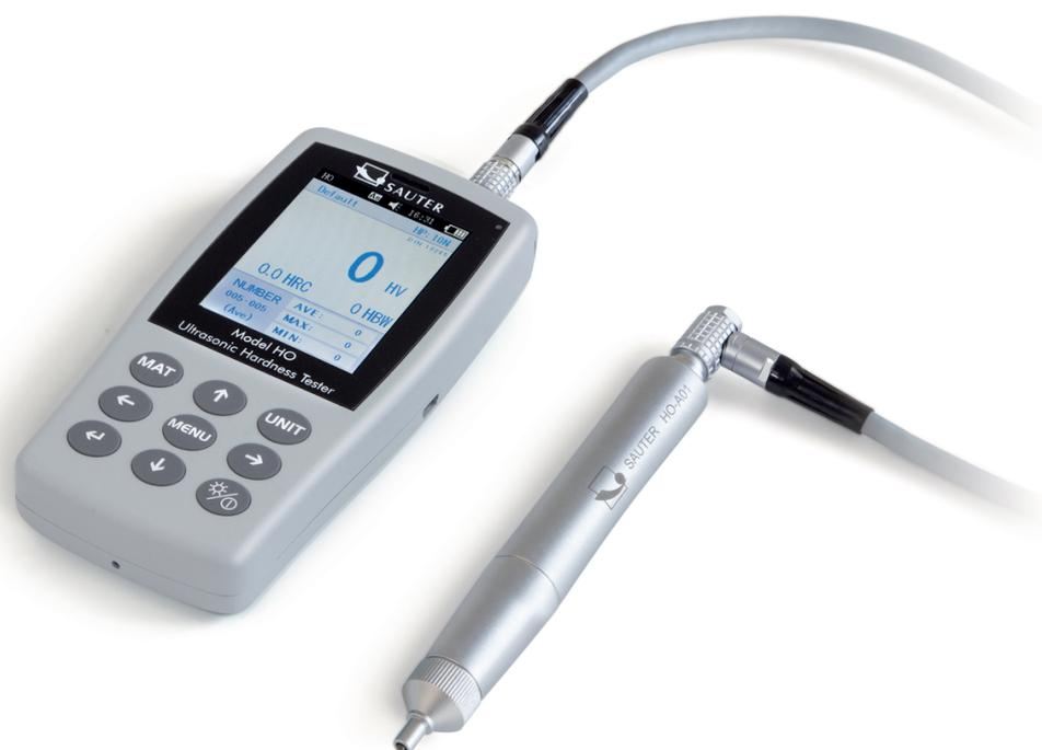
Strumento UCI Premium per prova di durezza per Rockwell, Brinell e Vickers
