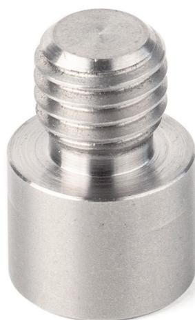
Adaptateur de filetage en acier pour les dynamomètres, les pinces et les bancs d'essai SAUTER, filetage extérieur : M10, filetage intérieur : M6
