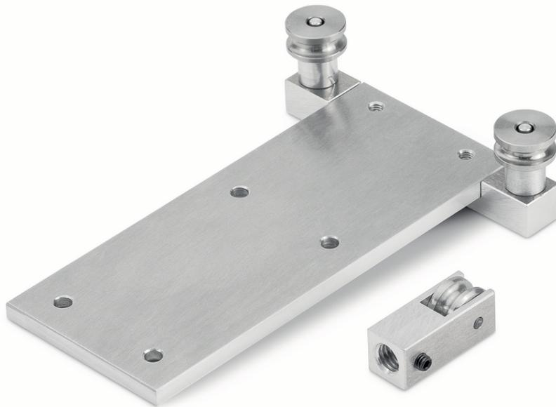
Tensiometer-Aufsatz für hochlastige Zugspannungsprüfungen bis 1000 N, Stahlaufsatz und Stahlrollen, Rollen nicht verstellbar
