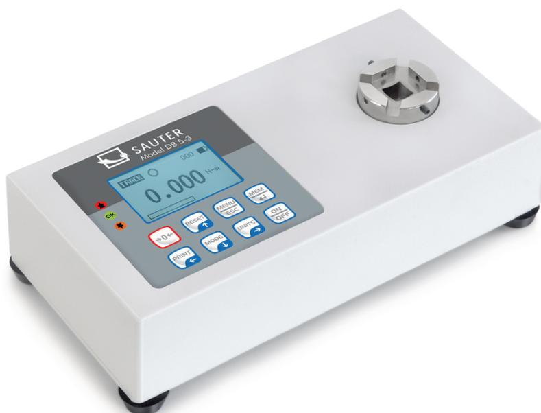
Test de couple confortable pour les outils
