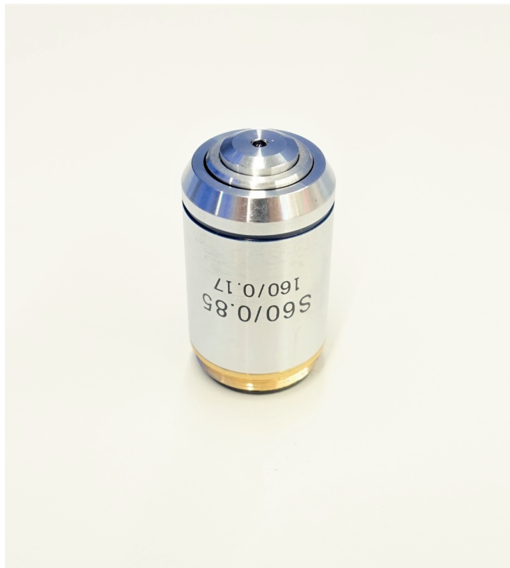
Achromatic objective lens, 60 x /0,85 (sprung) W.D. (0,4 mm)
