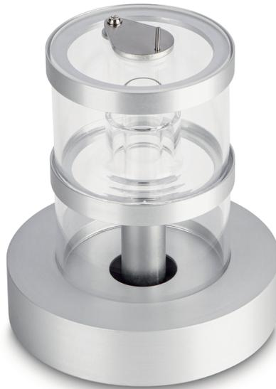
Verdunstungsfalle, minimiert Fehler durch Verdunstung beim Pipettieren bei kleinen Volumina von 10 µl bis 10 ml
