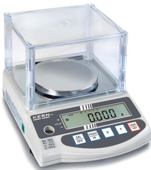
La clásica con el robusto sistema de medición de diapasón
