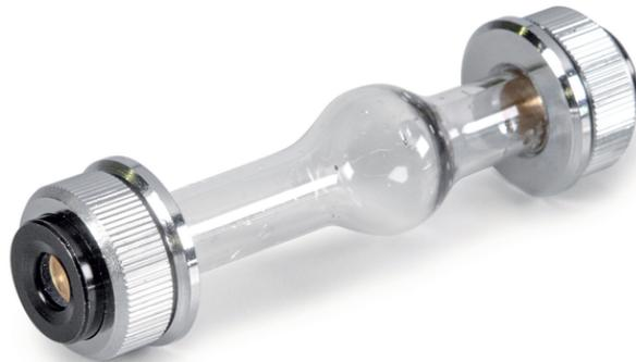
Cuvetta per polarimetro manuale
