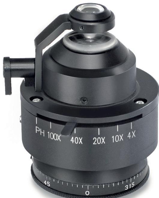
Condensateur « swing-out » N.A. 0,9 / 0,13 centrable (avec diaphragme d'ouverture)
