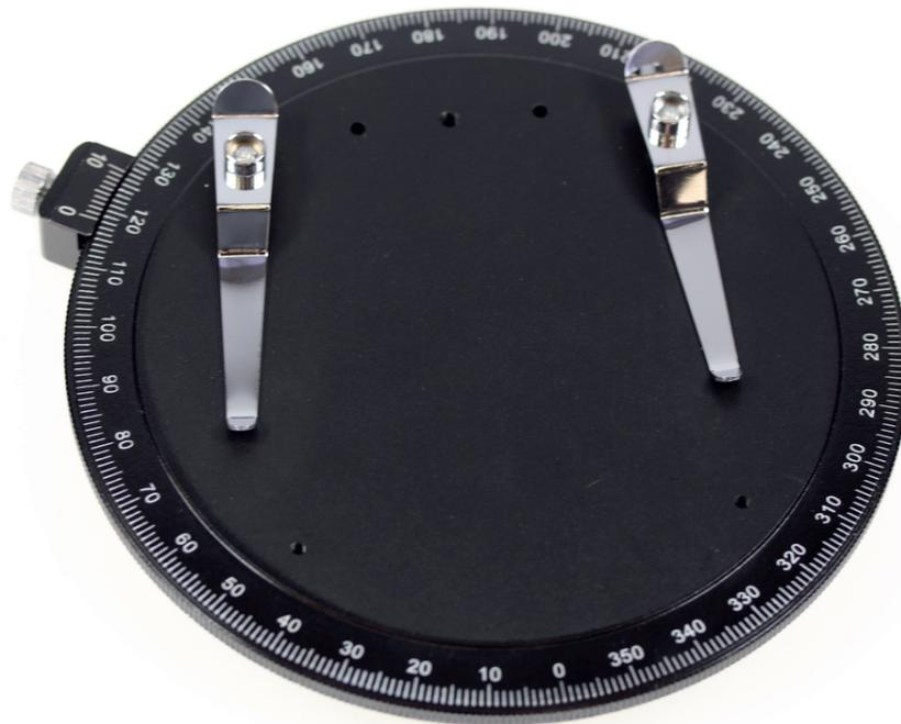
Table ronde rotative pour microscopes polarisants
