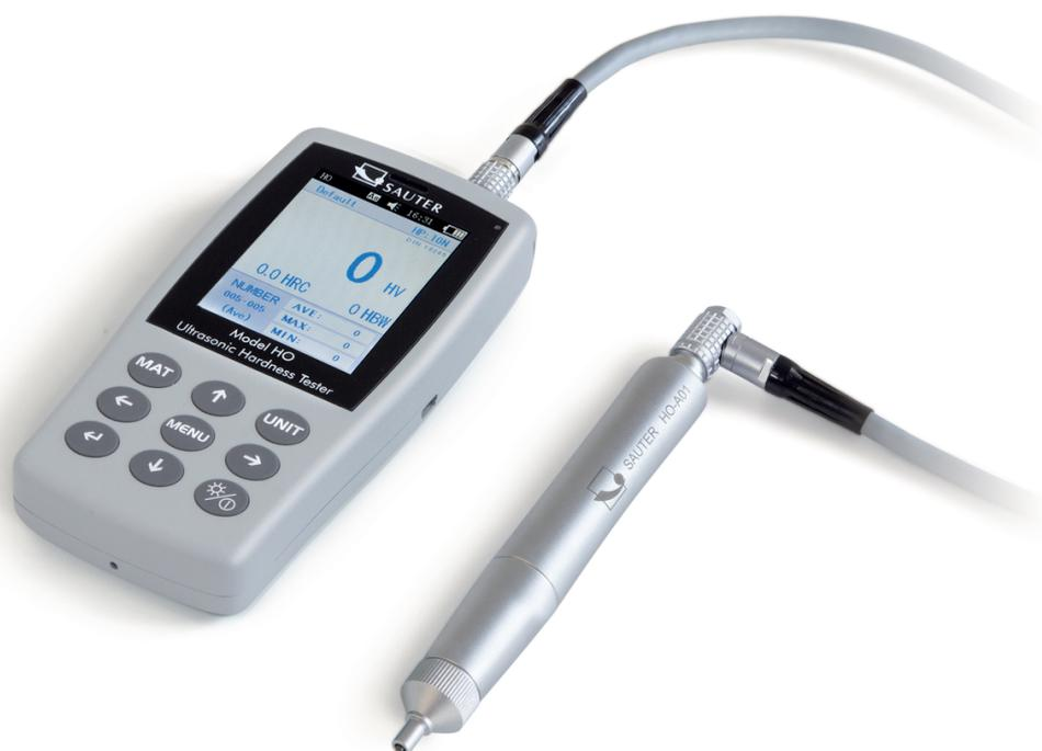
Duromètre UCI Premium pour les procédés de Vickers, Rockwell et Brinell
