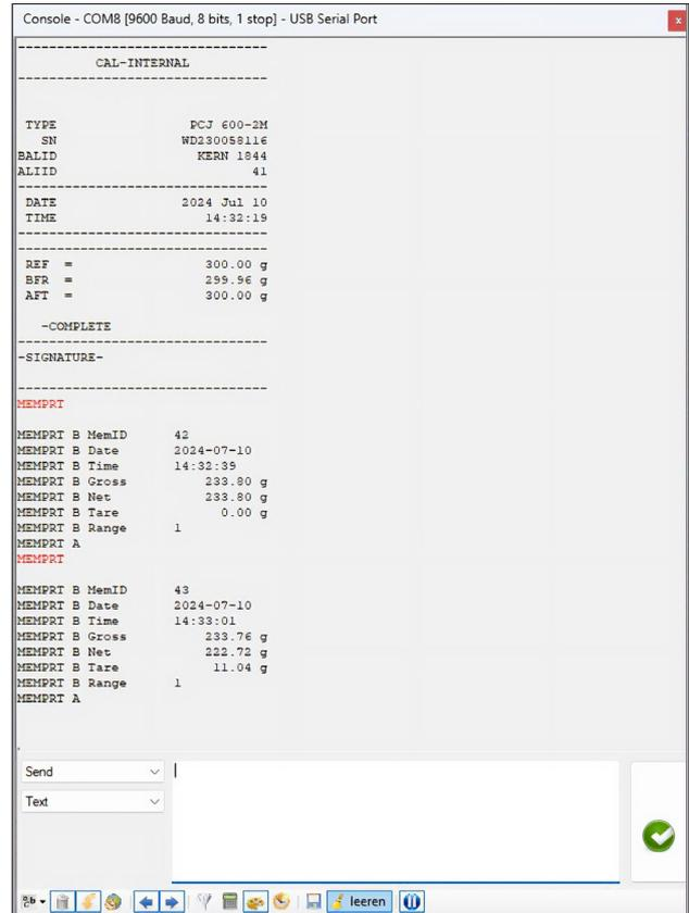
Consultation des résultats de mesure, du protocole de calibration ou des données de la mémoire alibi par des commandes à distance. Possibilité d'enregistrement sous forme de fichier texte.
