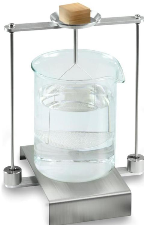
Fig.3: Pesée dans l'air
