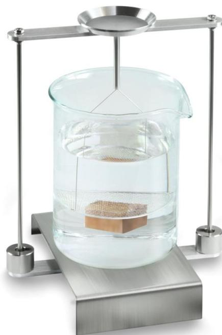
Fig. 4: Pesée dans un liquide auxiliaire
