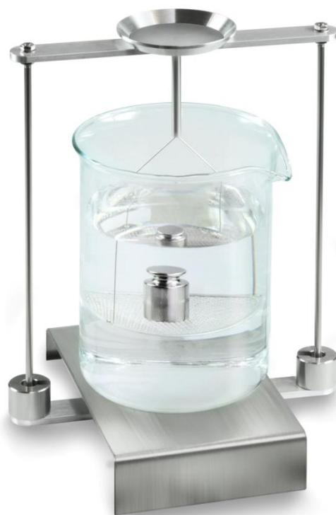
Fig. 2 : Pesée dans un liquide auxiliaire
