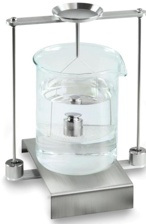
Fig.6: Pesée en liquide de contrôle
