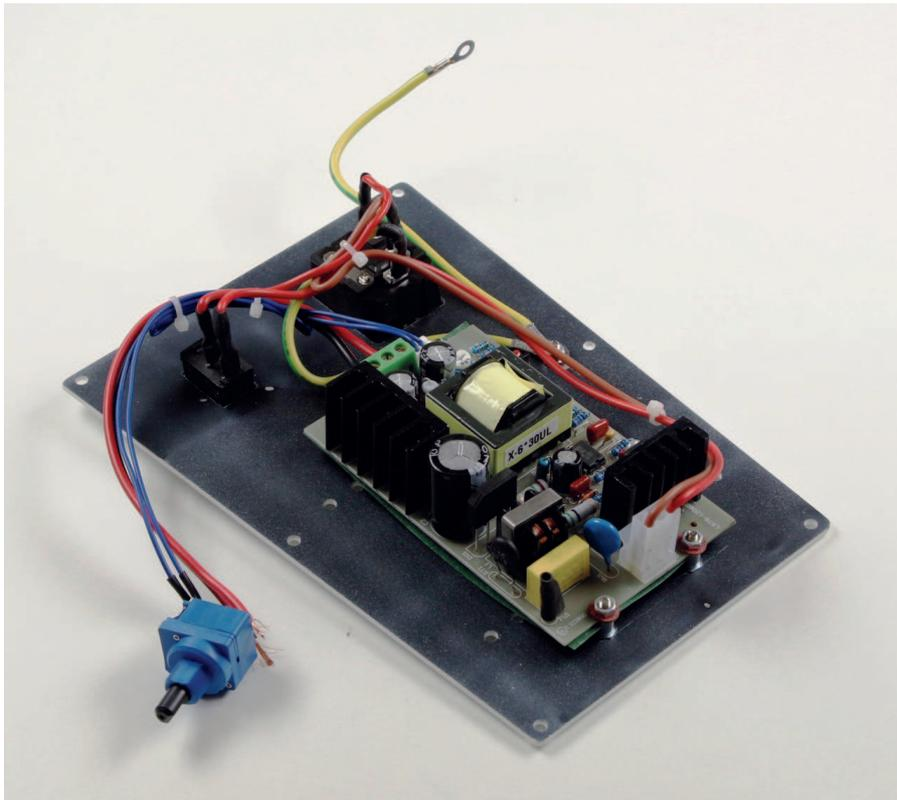
Transformador 6V / 30W, Adecuado para modelo KERN OKM 172/173
