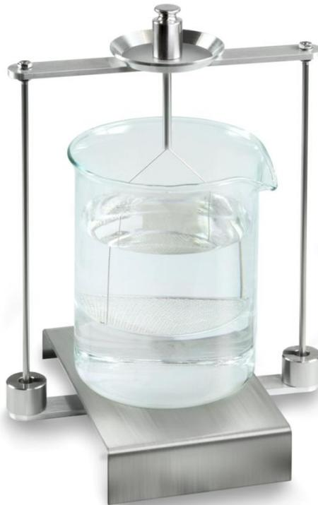
Fig. 1: Pesatura nell'aria
