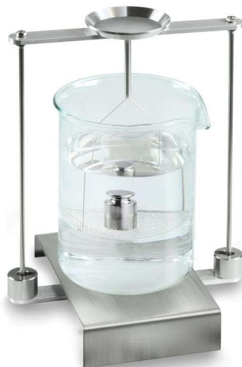
Fig. 2: Pesatura in liquido ausiliare
