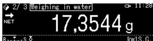
6. Aspettare la visualizzazione dell'indice di stabilizzazione (➔), quindi acquisire il valore di pesata, premendo il pulsante OK. La bilancia determinerà e visualizzerà la densità del corpo solido tenendo conto di spinta aerodinamica..
