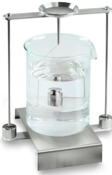
Fig. 2: Pesatura nel liquido ausiliare
