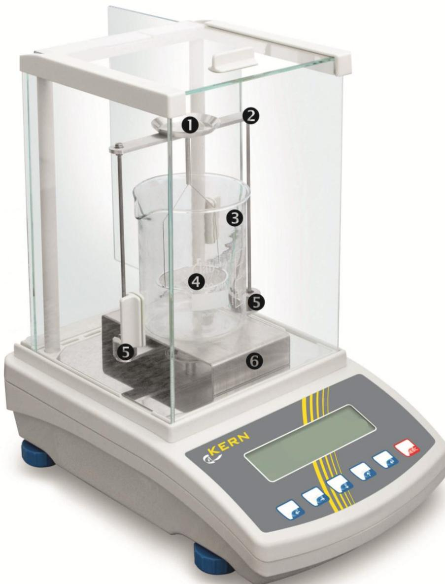
Esempio della bilancia con montato il kit per determinazione di densità KERNYDB-03
