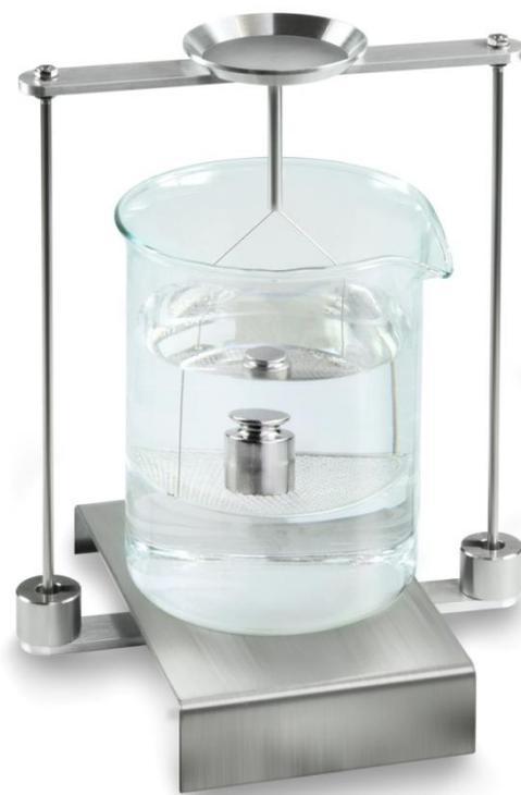
Fig. 6: Pesatura del liquido esaminato
