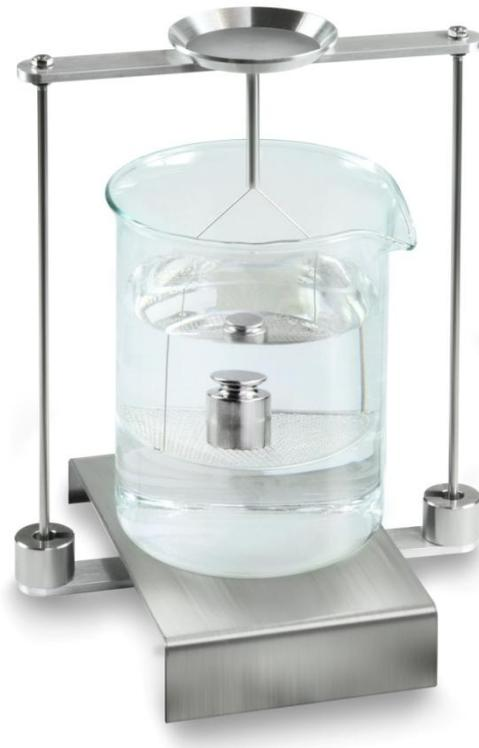
Fig. 2: Pesatura in liquido analizzato
