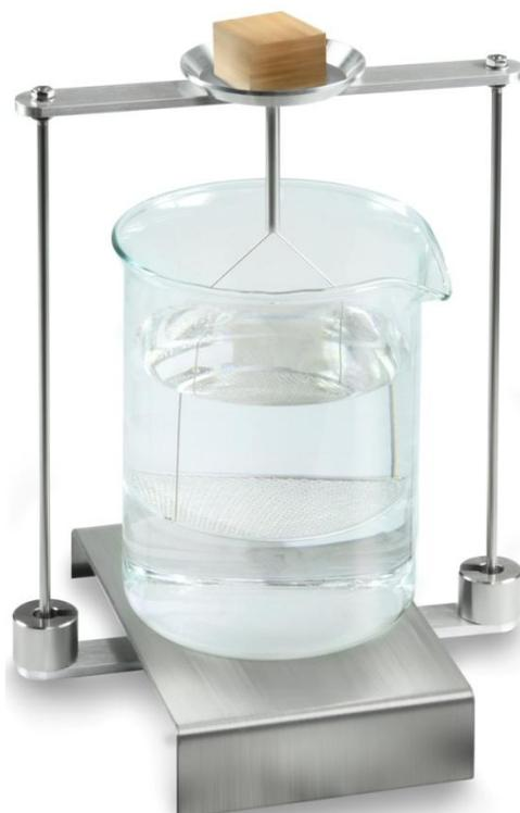
Fig. 3: Pesatura nell'aria
