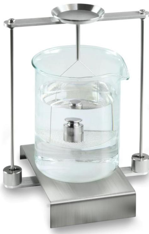
Fig. 2: Pesatura nel liquido ausiliare
