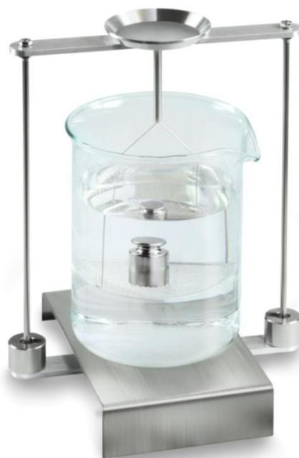
Fig. 2: "Pesatura nel liquido esaminato"
