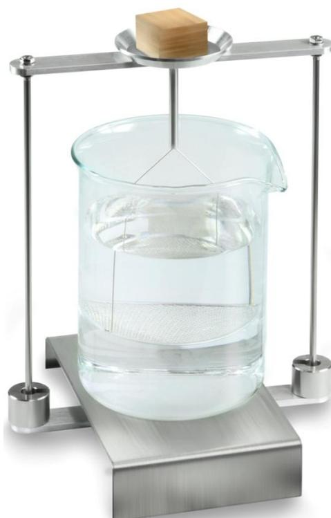
Fig. 3: Pesatura nell'aria
