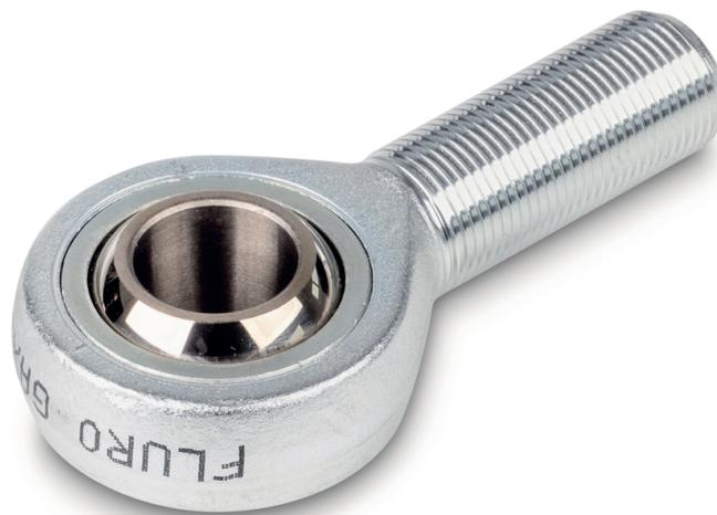
Testa snodata con filettatura M12 acciaio zincato, adatta solo per i modelli con carico nominale  $\leq 750$  kg
