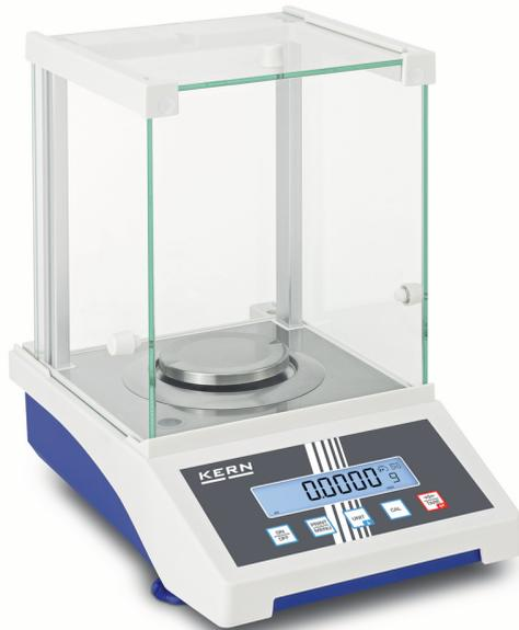
Einsteiger-Analysenwaage mit Kompaktgehäuse und interner Justierung
