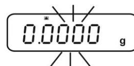
⇒ Retirer le poids d'ajustage et fermer les portes du brise-vent. Une fois l'ajustage correctement réalisé la balance revient automatiquement en mode de pesée. En cas d'erreur d'ajustage (p. ex. des objets se trouvent sur le plateau de pesée) un message d'erreur apparaît sur l'affichage, répétez la procédure d'ajustage. En cas de branchement d'une imprimante en option et fonction GLP activée intervient l'édition du protocole d'ajustage, voir au chap. 8.3.
