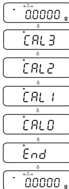
⇒ Une fois l'ajustage correctement réalisé la balance revient automatiquement en mode de pesée.
