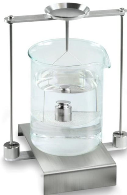
Afb. 2: “In de meetvloeistof wegen”
