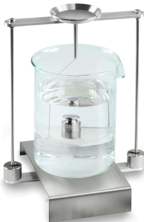
Afb. 2: In de testvloeistof wegen
