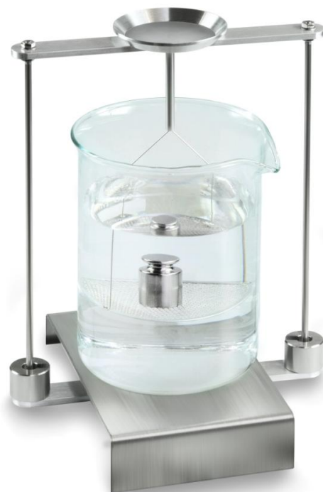
Afb. 6: In de meetvloeistof wegen
