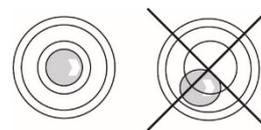
Procéder à la mise à niveau de la balance à l'aide des vis des pieds, jusqu'à ce que la bulle d'air du niveau se trouve dans le cercle prescrit.
