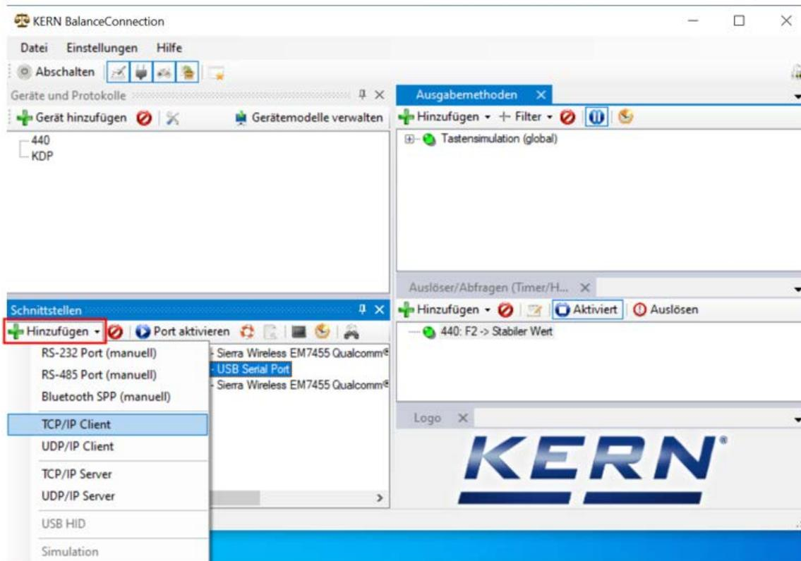
Choisir les caractéristiques du port IP et saisir l'adresse IP de la balance. Selon le type de liaison (ici TCP), ensuite registrer Port 23. Après cliquer sur „Appliquer“ et fermer la fenêtre en cliquant sur „X“:
