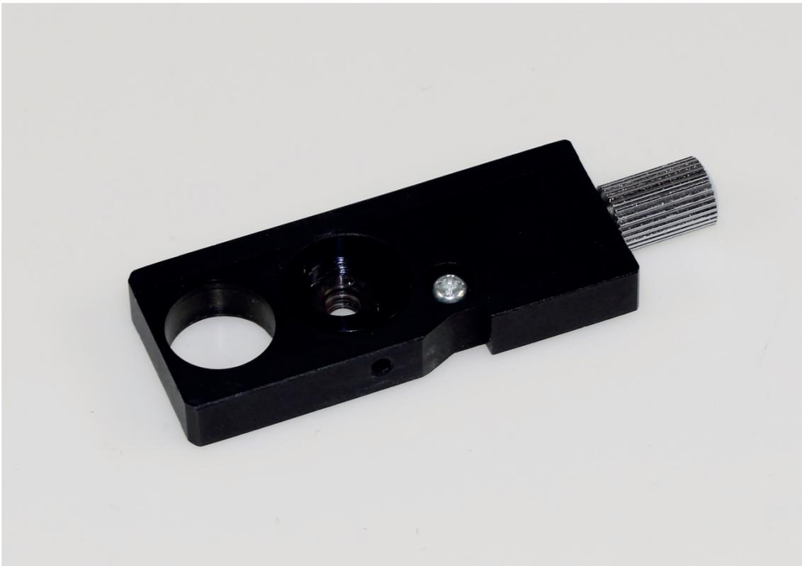
Bertrand-Linse, kann einfach aus dem optischen Pfad entfernt werden
