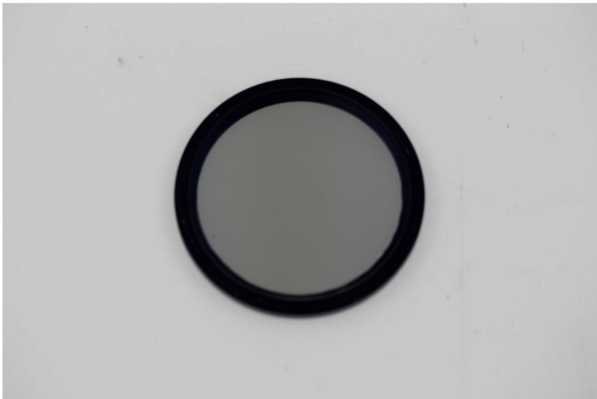
Analizzatore e anello (montato) per luce circolare a polarizzazione
