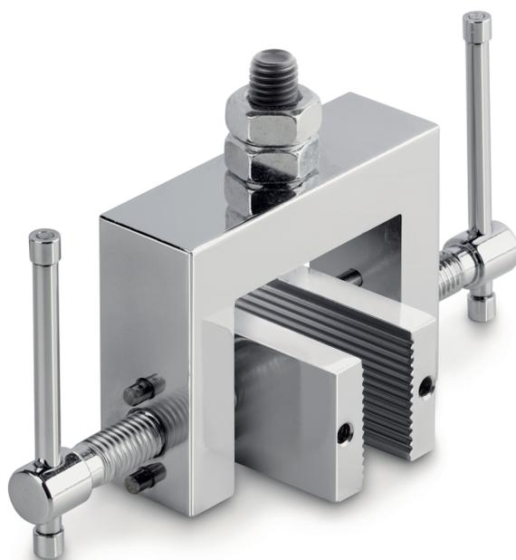
Pince de serrage à vis avec deux mâchoires larges pour tests de traction et de décollement
