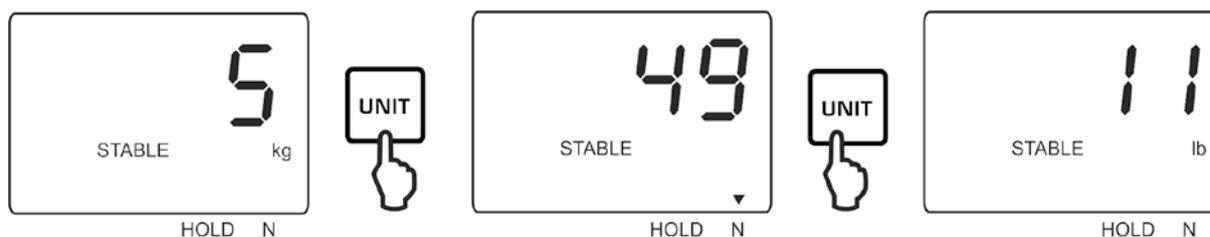
Unidades de pesagem „N” e „lb” podem ser ligadas (on) ou desligadas (off) no ponto do menu „F2 UNT”.
