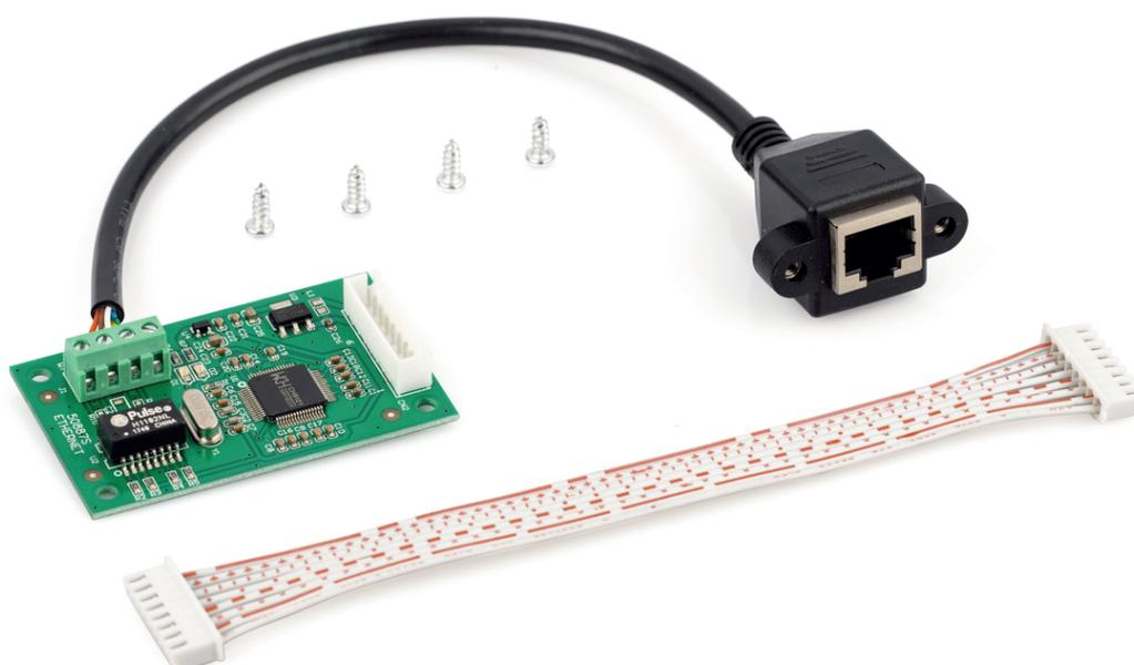
Interfaccia Ethernet per il collegamento a una rete Ethernet basata su IP, non integrabile successivamente
