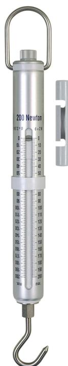
Jauge de force mécanique précise, avec boîtier en aluminium robuste et lecture en Newton
