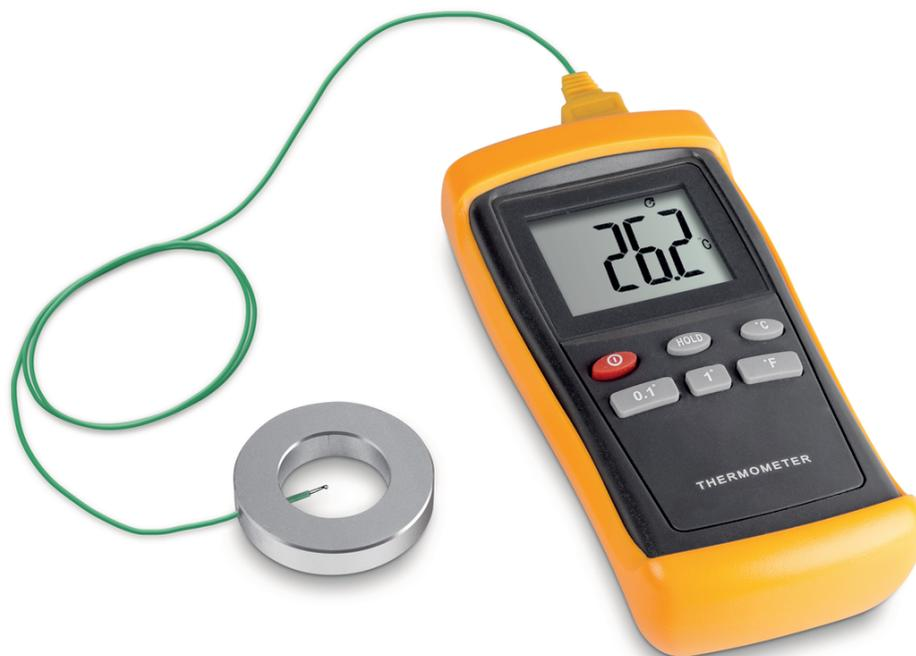
Set de calibración de temperatura compuesto por una sonda medidora y un indicador
