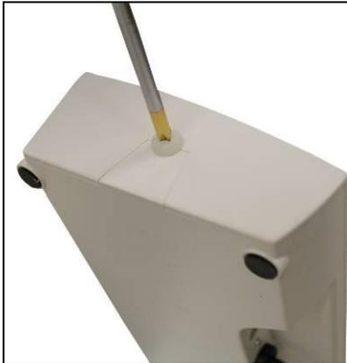
Am Anzeigegerät die Kunststoffabdeckungen an beiden Seiten mit einem Schraubendreher entfernen.
