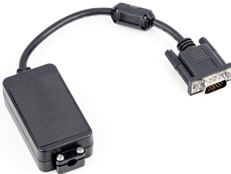
Adaptador de interfaz con cable. Interfaz con analógica (0 - 10 V)
