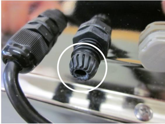
Durch diese Öffnung das KXS-A04-Kabel führen.
