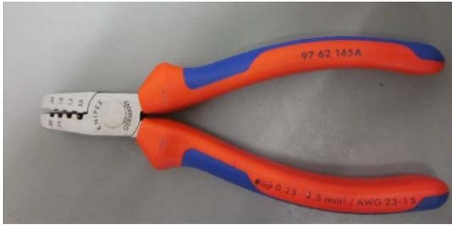
Die kleinstmöglichen Adernhülsen verwenden und diese mit der Adernendhülsenzange auf die Leitung pressen (s. diese Abbildungen)
