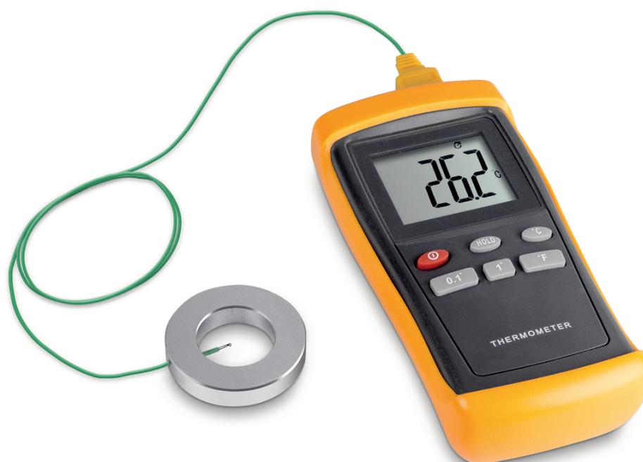
Jeu d'étalonnage de la température constitué d'un capteur et d'un afficheur
