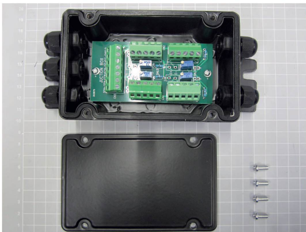
Caja de conexiones
