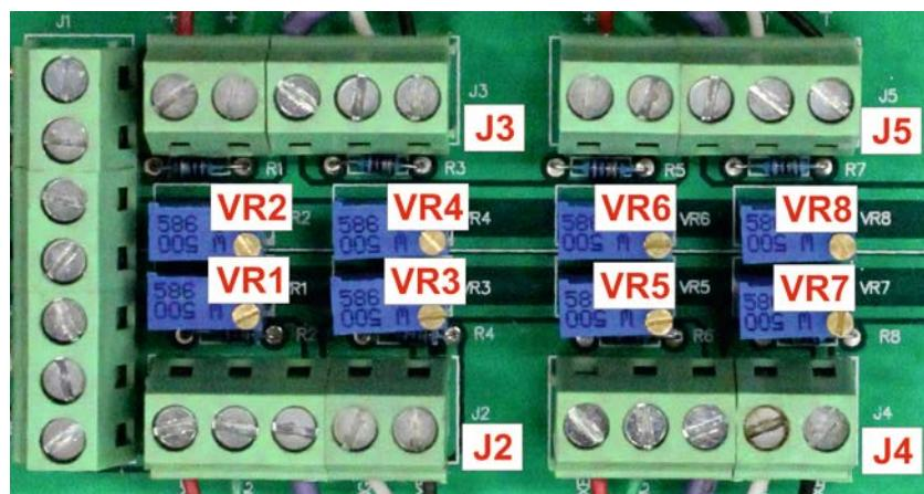
Kalibrace vážní buňky J2 se provede pomocí dvojice potenciometrů VR1.
