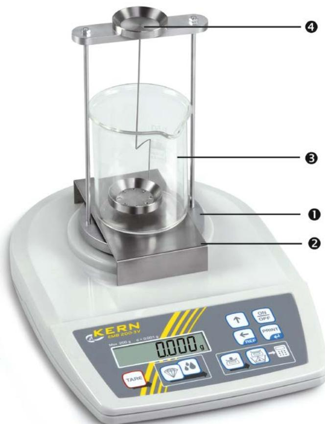
Dibujo 1: La balanza KERN EMB 200-3V con set para la determinación de la densidad KERN YDB-01 (numeración – ver el capítulo 1)
